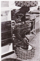
Train arrière à bras tirés articulés par de grosses rotules plastique. Demi-arbres plastique également particulièrement solides.
