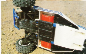
La batterie de propulsion est accessible par le dessous du châssis. Attention à l'accumulation de terre entrant par l'ouverture laissée libre !
