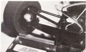
Train AV à double triangulation (rigide).
