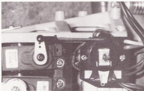
Le variateur à « plots » semble robuste. Les résistances sont disposées à l'arrière pour un meilleur refroidissement.
